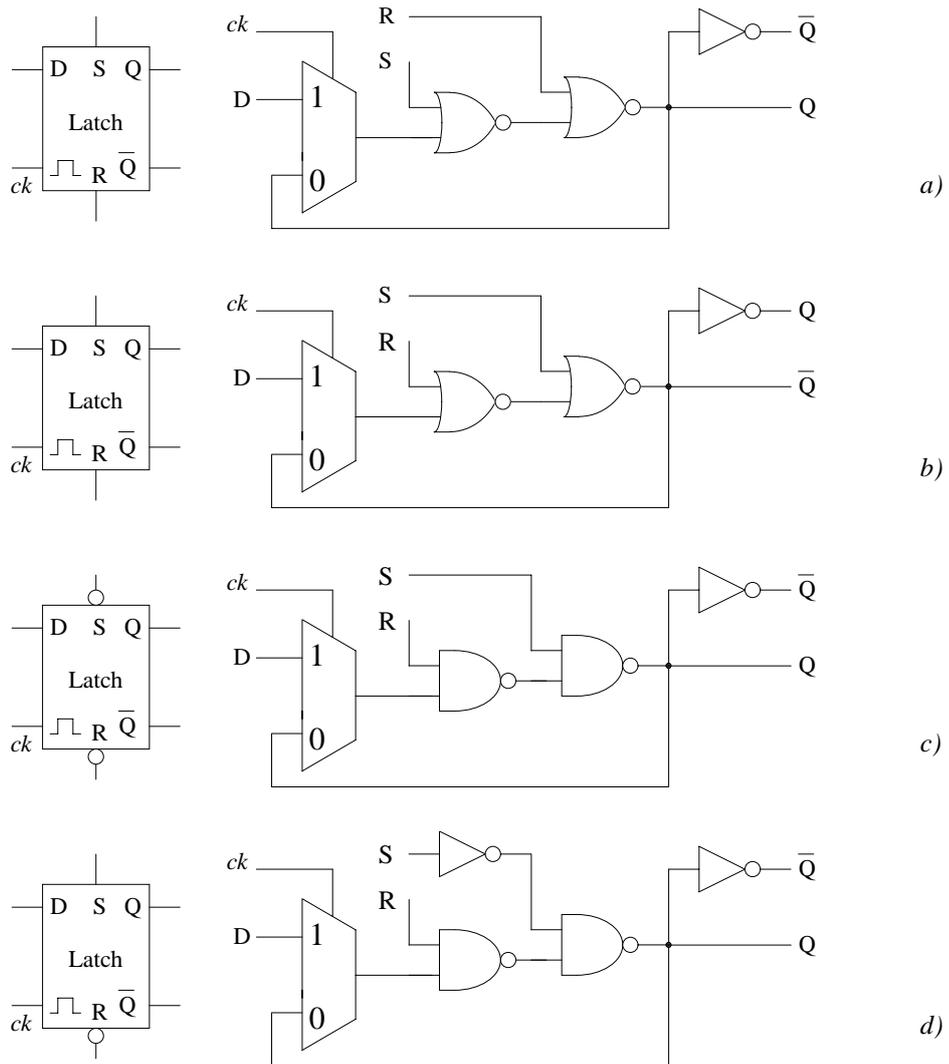
**Figura 44.** Simboli circuitali ed esempi di schemi elettrici di latch con segnali di set e reset asincroni.
