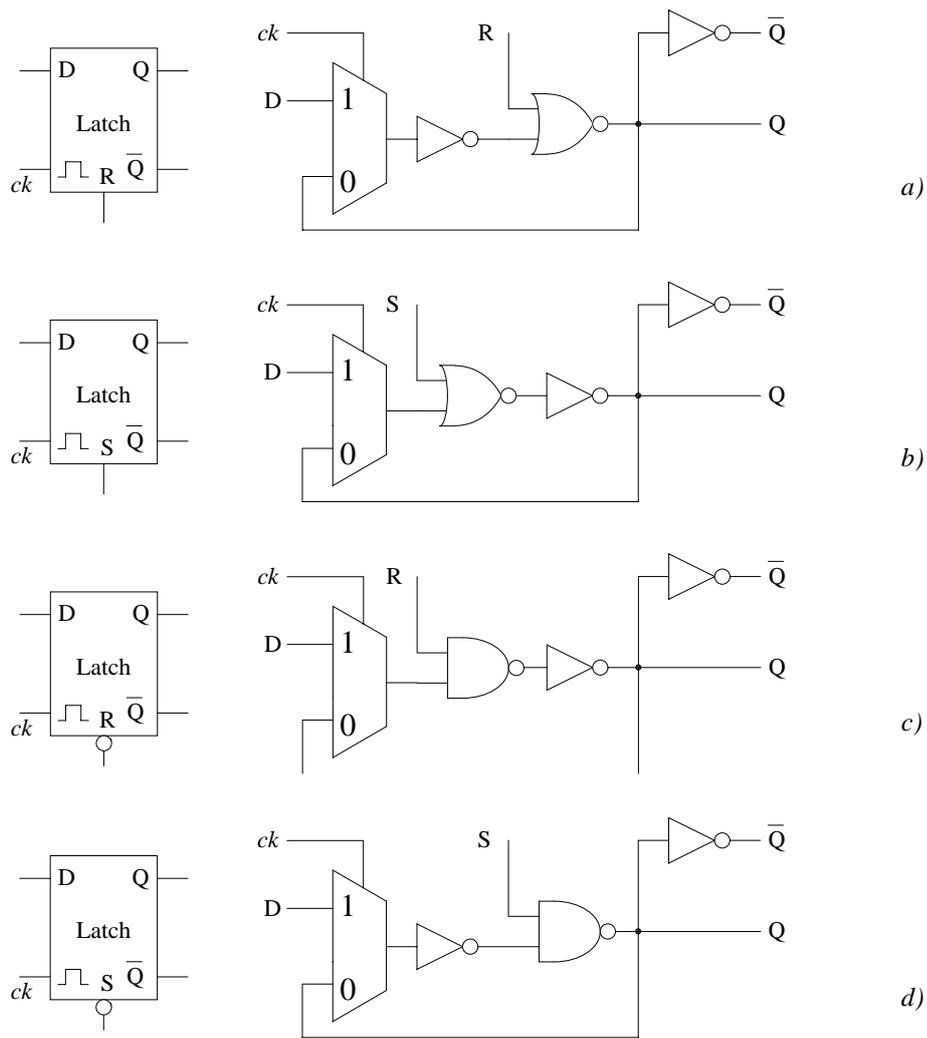
**Figura 43.** Simboli circuitali ed esempi di schemi elettrici di latch con segnali di set o reset asincroni.
