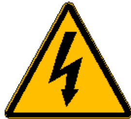
Tensione elettrica pericolosa
