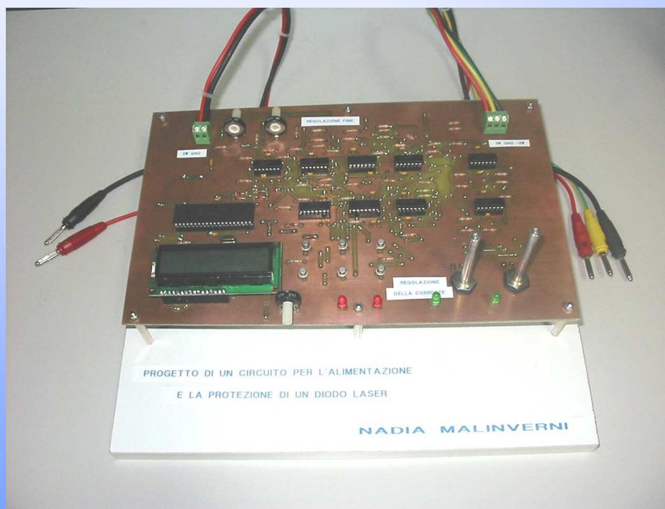
**Il circuito realizzato costituisce uno studio di fattibilità preparatorio alla realizzazione di un alimentatore per diodi laser, genera una corrente scalata rispetto a quella richiesta per l'alimentazione di diodi laser e alimenta dei diodi LED.**
