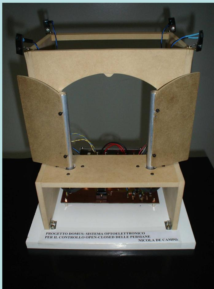
Apertura e chiusura automatica delle persiane a seconda della rilevazione luminosa
