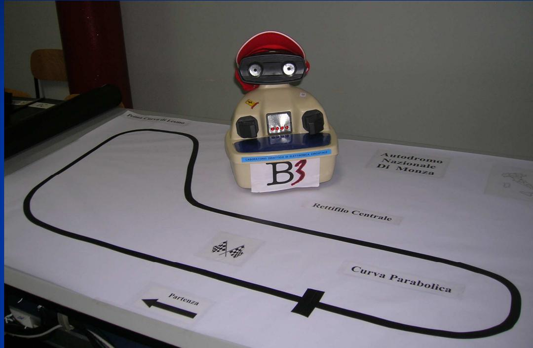
Il sistema realizzato permette all'automa di muoversi lungo il percorso tracciato grazie alla rivelazione delle variazioni del coefficiente di riflessione.
