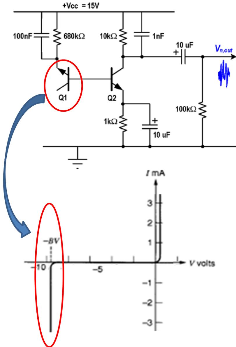
Per generare "elevato" rumore si sfrutta la *giunzione base-emettitore di Q1 polarizzata in inversa, nella regione di breakdown*
