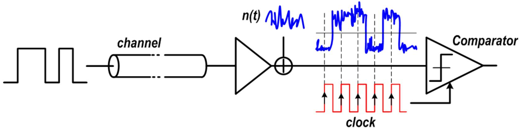
I segnali elettrici trasmessi codificano un livello logico (0, 1). I segnali ricevuti sono attenuati dal canale di trasmissione e vi è sovrapposto il rumore elettronico, introdotto dal canale, dai circuiti di trasmissione e ricezione.
