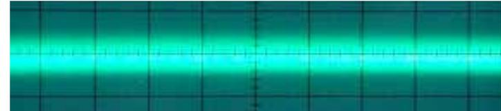
Impostando il guadagno verticale dell'oscilloscopio al massimo, senza segnale in ingresso, la traccia non è nitida e mostra fluttuazioni casuali.
