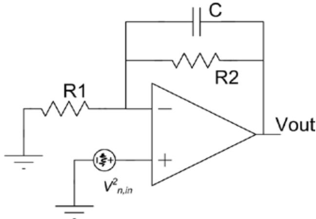
Inserisco il generatore di rumore equivalente in serie all'ingresso positivo. Il rumore vede una configurazione NON-INVERTENTE
