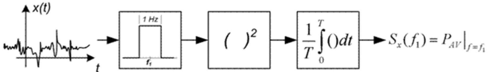
Regolando la frequenza centrale del filtro è possibile misurare, frequenza per frequenza, la potenza del segnale  $X(t)$ . L'operazione viene eseguita automaticamente dallo strumento
