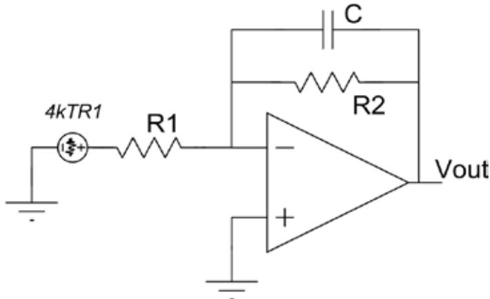
Il rumore in tensione di R1 vede una configurazione non-invertente:
