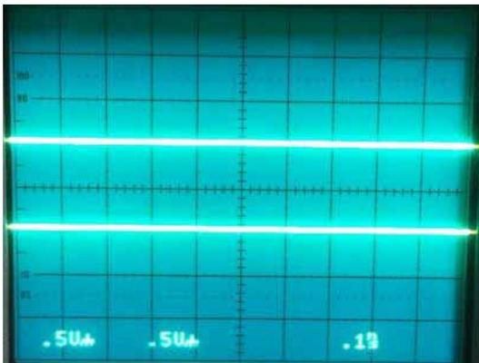
Disattivare i due canali e misurare la distanza fra le due tracce orizzontali.
