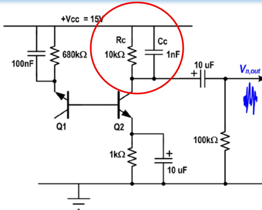
Sostituire  $R_c$  con un resistore da 4.7k e ripetere la misura. Di quanto ti aspetti che cambi la varianza di rumore?
