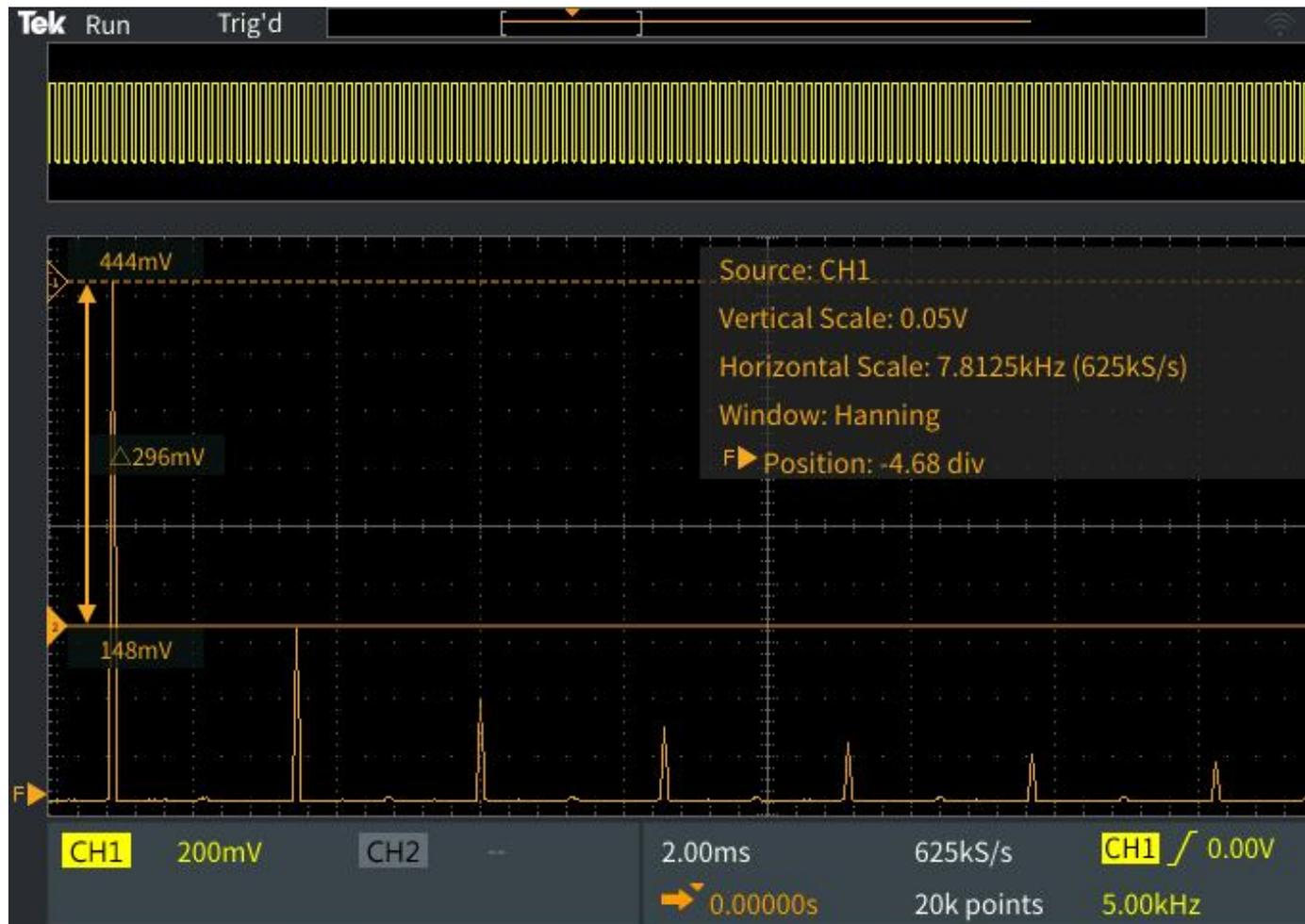
L'oscilloscopio permette di visualizzare la trasformata di Fourier del segnale di ingresso. L'asse Y riporta l'ampiezza delle armoniche, misurata in  $V_{rms}$  o in  $dBV_{rms}=20\log(V_{rms})$
