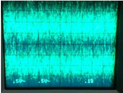
Regolare la posizione verticale dei due canali in modo da vedere DUE tracce separate da una zona scura
