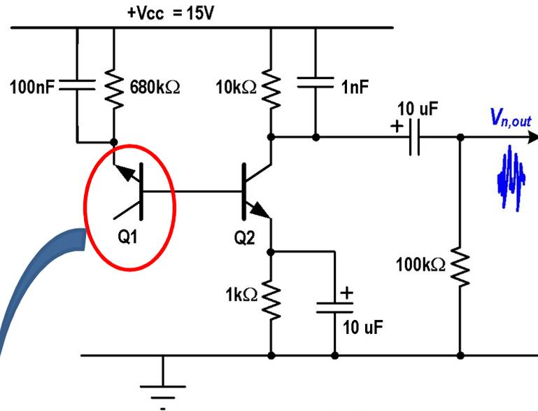
Per generare “elevato” rumore si sfrutta la **giunzione base-emettitore di Q1** polarizzata in inversa, **nella regione di breakdown**
