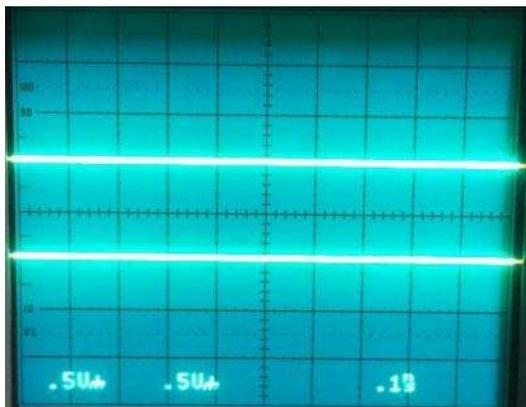
Disattivare i due canali e misurare la distanza fra le due tracce orizzontali.
