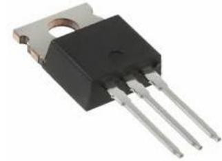
equivale a due SCR collegati in antiparallelo con il Gate in comune
