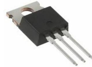
è utilizzato solitamente per *innescare* il *Gate* di un TRIAC o un SCR
