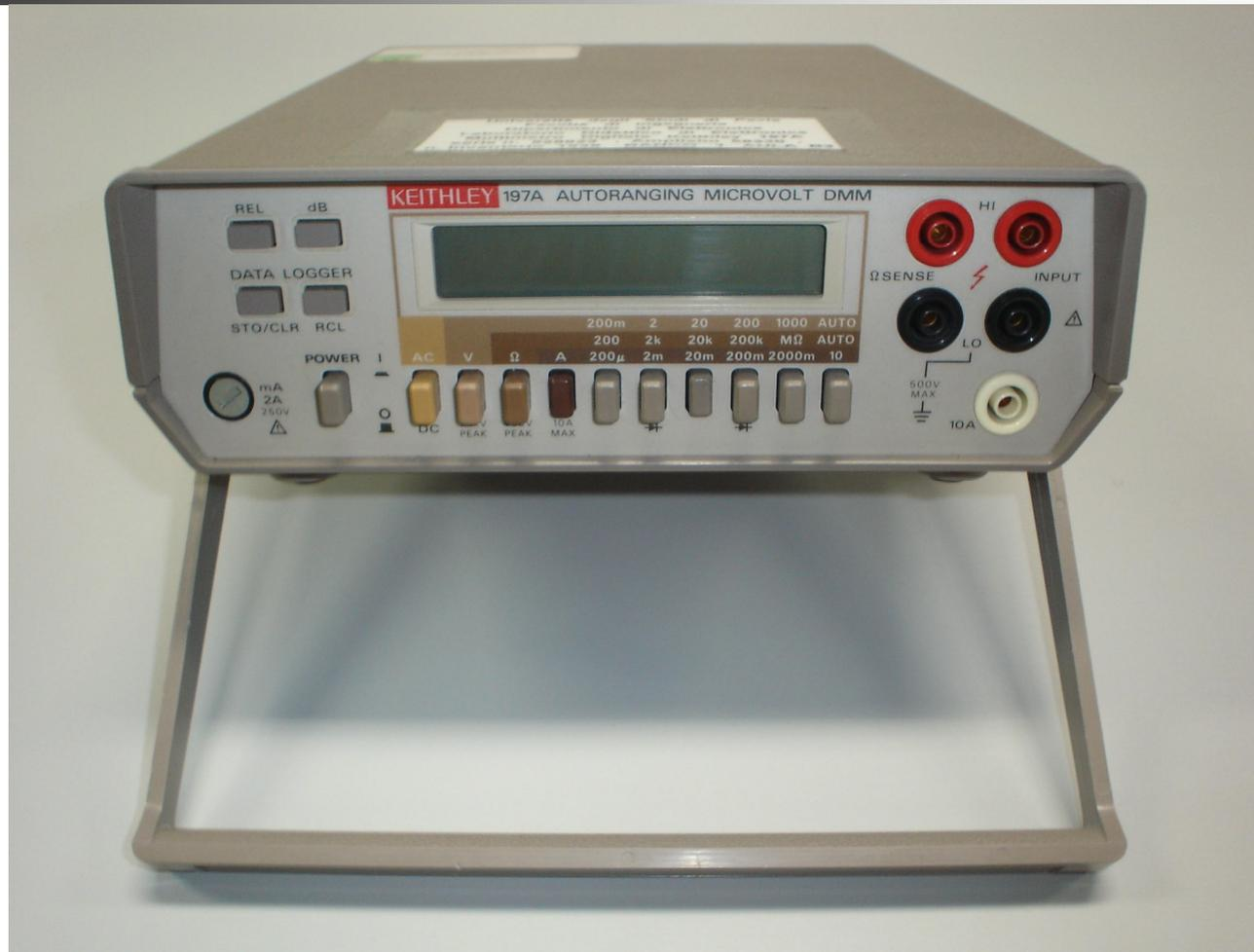
**Strumento di misura in AC e DC di: Tensione, Resistenza e Corrente**
