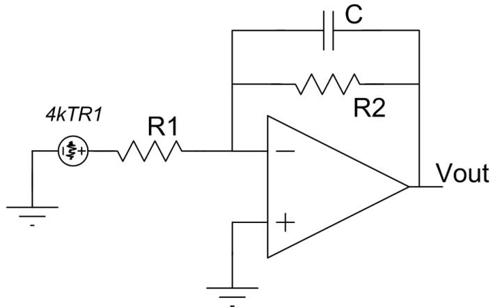
Il rumore in tensione di R1 vede una configurazione non-invertente:
