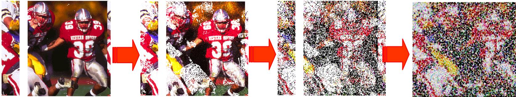
In segnali video digitali le informazioni di colore e intensità sono codificate in modo numerico (bits). Il rumore può corrompere completamente alcune parti dell’immagine
