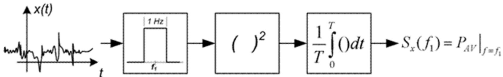
Regolando la frequenza centrale del filtro è possibile misurare, frequenza per frequenza, la potenza del segnale  $X(t)$ . L'operazione viene eseguita automaticamente dallo strumento
