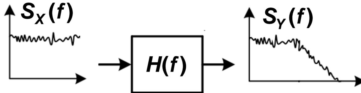
Se un segnale aleatorio con densità spettrale di potenza  $S_X(f)$  viene applicato all'ingresso di un quadripolo lineare con funzione di trasferimento  $H(f)$ , la densità spettrale di potenza all'uscita  $S_Y(f)$  vale:
