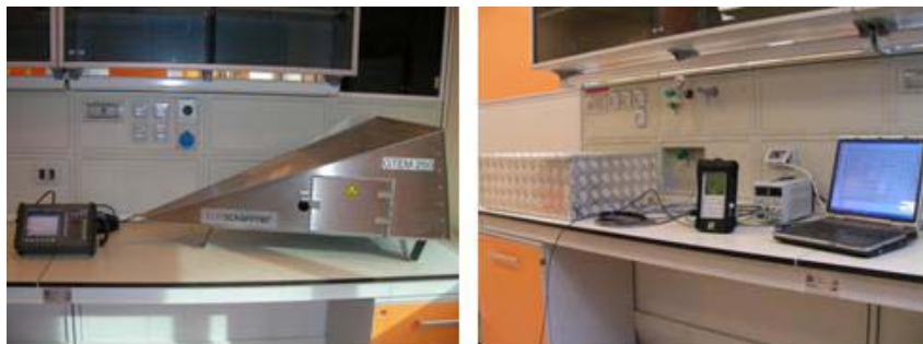
Figura 1: Set-up di misura per le alte frequenze (a sinistra) e set-up di misura per le basse frequenze (a destra)
