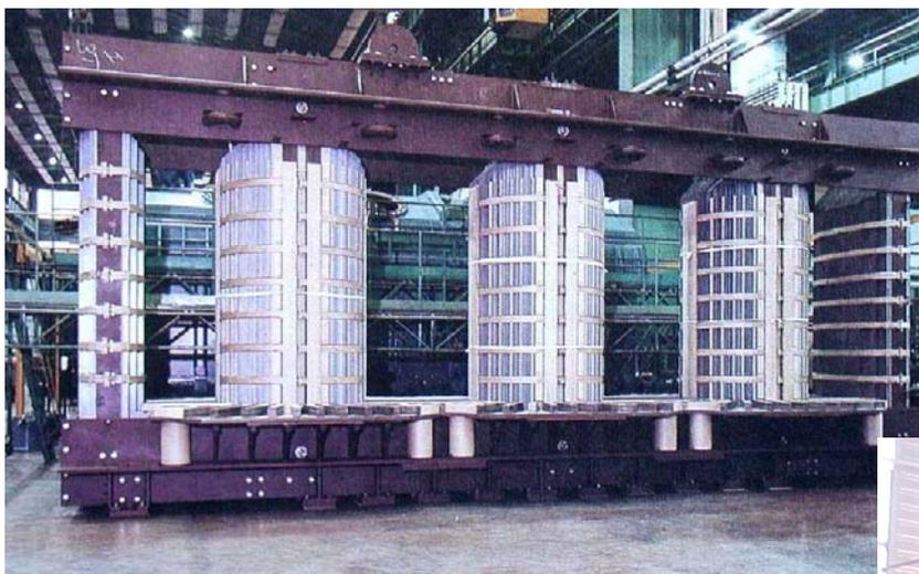
Per trasformatori trifase di potenza molto elevata si può utilizzare il nucleo a 5 colonne (analogo al nucleo a mantello per il monofase), al fine di ridurre l'altezza dei gioghi e quindi l'altezza dell'intero trasformatore.
