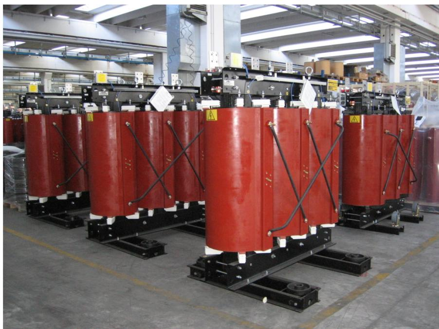
Trasformatori a secco isolati in resina 15 kV/400 V
