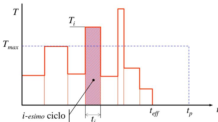
L'andamento della temperatura durante la vita operativa del materiale può essere schematizzato in  $n$  cicli termici della durata  $t_i$  e temperatura  $T_i$ .
