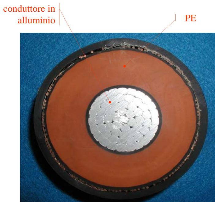
Cavo isolato in PE per 245 kV
