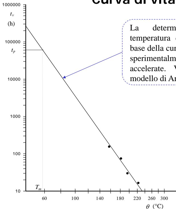
La determinazione della massima temperatura di servizio viene fatta sulla base della curva di vita termica determinata sperimentalmente con prove di vita accelerate. Viene di solito seguito il modello di Arrhenius.
