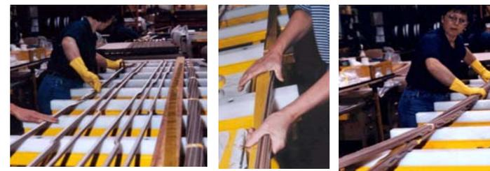
I conduttori che costituiscono le barre possono essere pieni (raffreddamento indiretto) o forati (raffreddamento diretto a idrogeno o ad acqua demineralizzata). La barra "nuda" così composta è compattata in temperatura sotto pressa.
