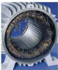
Corto circuito in una fase dovuto a rotore bloccato:
