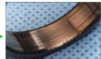
Anello esterno di un cuscinetto a sfere con le guide usurate da particelle abrasive
