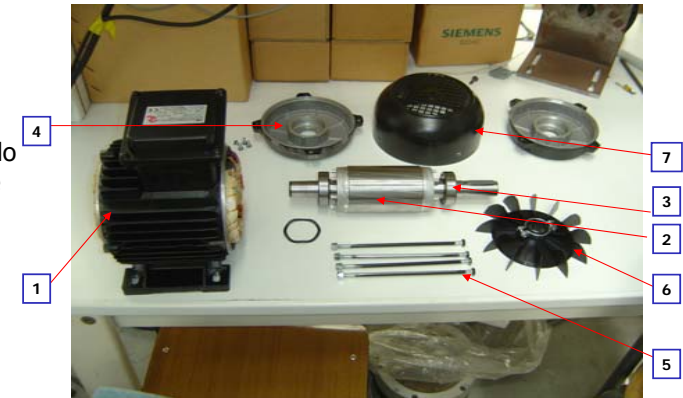
Motore asincrono trifase con rotore a gabbia pressofuso in alluminio, alimentato in bassa tensione.
