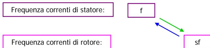
Il campo rotante prodotto dalle correnti di rotore a frequenza  $sf$  interagisce con il campo rotante di statore (freccia da  $sf$  a  $f$ ), dando origine alla coppia elettromagnetica.
