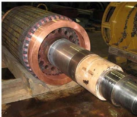
Rotore a gabbia a barre di rame saldate
