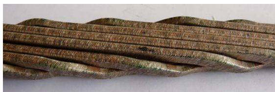
Costruzione della bobina con trasposizione
