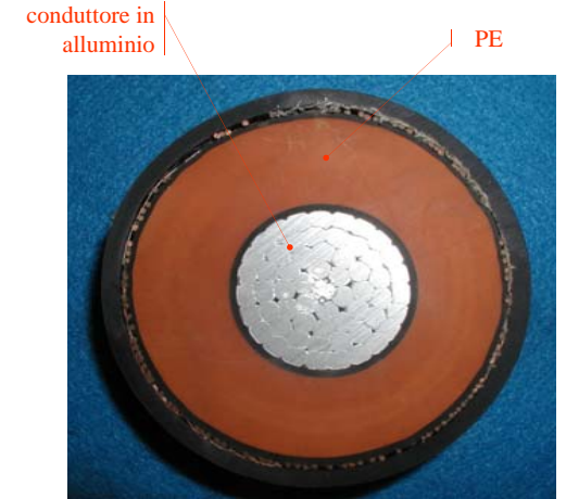
Cavo isolato in PE per 245 kV
