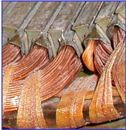
Avvolgimento di rotore in filo di rame smaltato di un motore asincrono di piccola potenza
