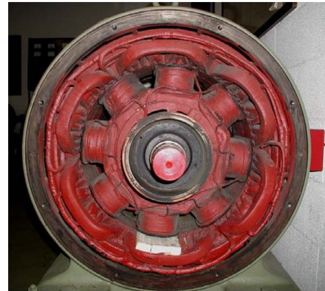
Macchina sincrona 34 kVA – asse orizzontale
