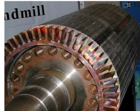
Rotore a gabbia a barre di rame saldate
