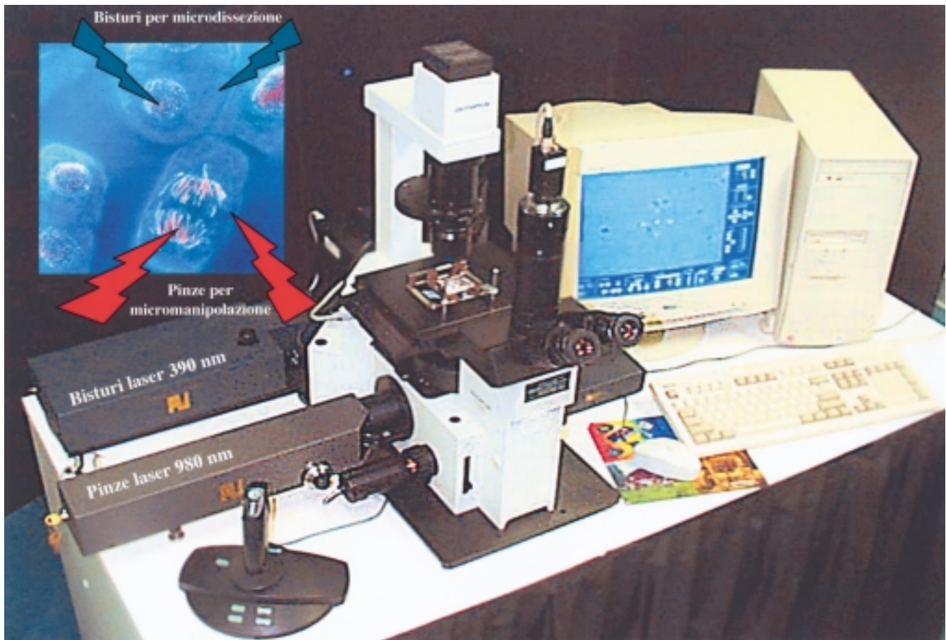
Figura 2 - Stazione di lavoro per microchirurgia cellulare laser CELL ROBOTICS (cortesia della Olympus Italia). I due fasci laser sono convogliati al preparato istologico o cellulare portato da un microscopio rovesciato. Le operazioni di "pinza" e "bisturi" sono compiute con leve di comando (joysticks) e seguite su monitor.
